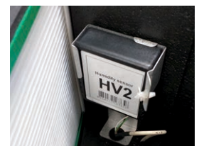
Sonde hygrométrique « Plug & Play » sur son support.
